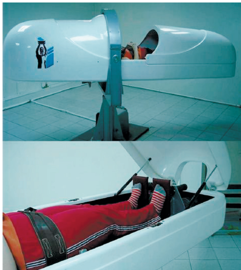
Рисунок 7. Центрифуга короткого радиуса действия «САЛЮТ» [18]
